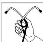
U kunt de spanning in de oorbeugel verminderen door de oorbuijzen in de bocht bij de oordopjes beet te pakken en langzaam van elkaar te trekken totdat de beugel volledig uitgerekt is.
