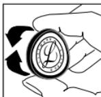
Esaminare visivamente la ghiera per verificare che il bordo flessibile sia inserito in modo uniforme. Se necessario, piegare il gruppo, tenendo il bordo esterno della ghiera fra le dita. Ruotare il gruppo di un quarto di giro e ripetere l'operazione di piegatura.
