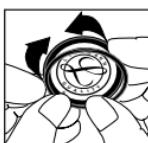
Leg de buigzame rand van het membraan in de gteuf van de ring. Dit lukt het beste wanneer u begint met de ring boven het leesbare gedeelte van het membraan.
