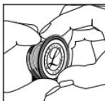
För att fästa membranringenheten på bröststycket, passa in ringfåran (med membranet fastsatt) vid en punkt på bröststycket och håll det på plats med tummarna.
