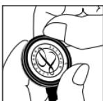
Am Rand den Kontakt zwischen Membran und Ring auf gleichmäßigen Sitz prüfen. Geringfügige Änderungen können durch leichtes Wegziehen und Abrollen des Rings von der Membran vorgenommen werden.
