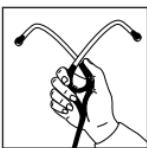
Per aumentare la tensione elastica, afferrare l'auricolare con una mano nel punto in cui i tubicini auricolari entrano nei tubi di plastica, quindi comprimerla fino a far toccare i tubi in plastica dei tubicini auricolari. Ripetere l'operazione se necessario.
