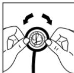
Hold stetoskopet med membransiden ned, grip tak i festeringen med begge tommelfingrer og rull den av stetoskophodets kant. Fjern membranen fra festeringen og rengjør delene i såpe og vann eller tørk av med alkohol. Stetoskophodets overflater kan tørkes av med alkohol eller såpe og vann. Tørk alle deler og overflater grundig av før membranen settes på igjen.
