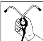
Pour augmenter la tension du ressort, tenez la lyre d'une main à l'endroit où les branches s'emboîtent dans la tubulure et serrez jusqu'à ce que les tubulures des branches se touchent. Au besoin, répétez l'application.
