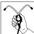
Um die Federspannung zu erhöhen, die Ohrbügel am Übergang in die Plastiksäule festhalten und zusammendrücken, bis sich die Plastiksäule der Ohrbügel berühren. Den Vorgang eventuell wiederholen.
