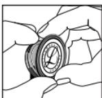
Kiinnitä reuna-kuuntelukalvoyhdistelmän rintakappaleeseen kiinnitämällä reunukan ura (johon kuuntelukalvo on kiinnitetty) rintakappaleen yhdestä kohdasta ja pitämällä sitä paikoillaan peukaloilla.
