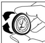
Kontrollera ringen så att den mjuka membrankanten är jämnt ihoppassad på ringens insida. Om det är nödvändigt, böj på membran-ringenheten genom att knipa ihop den yttre ringkanten mellan tummen och fingrarna. Vrid membran-ringenheten ett kvarts varv och upprepa förfarandet.
