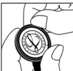
Inspectez le bord où la membrane s'engage dans la rainure pour vérifier qu'elle est engagée de manière uniforme. Il est possible d'effectuer des ajustements mineurs en tirant légèrement sur la bague et en la roulant un peu hors de la membrane pour lui permettre de se mettre en place.
