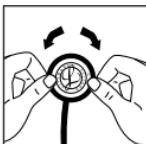
Håll bröststycket med membranet nedåt, pressa ringen ur dess fära med tummarna och rulla därefter av den från bröststyckskanten. Avlägsna membranet från membranringen och rengör delarna med tvålvattnet eller torka av dem med alkohol. Torka av bröststyckets ytor med alkohol eller tvålvattnet. Torka alla delar och ytor ordentligt innan bröststycket monteras ihop igen.
