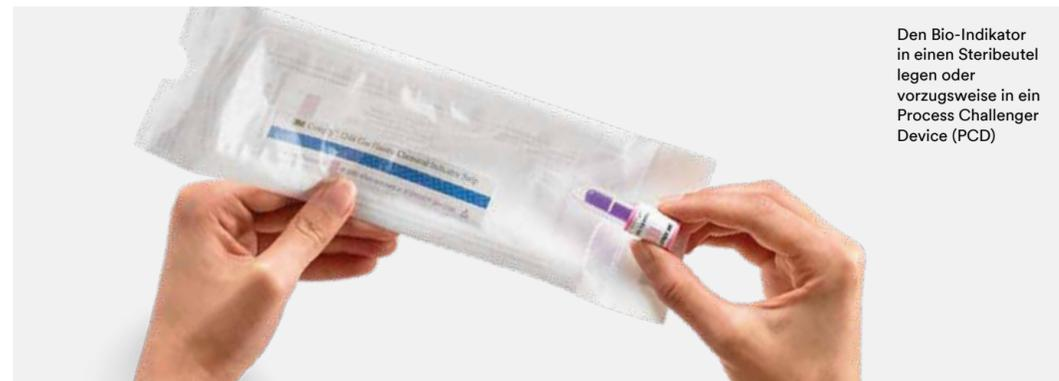
Den Bio-Indikator in einen Steribeutel legen oder vorzugsweise in ein Process Challenger Device (PCD)
