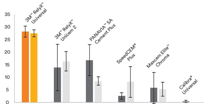
Resistencia de adhesión al cizallamiento (MPa) a dentina tras envejecimiento artificial
