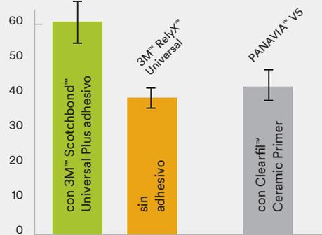
Resistencia de adhesión al cizallamiento (MPa) a zirconia en modo autocurado.
