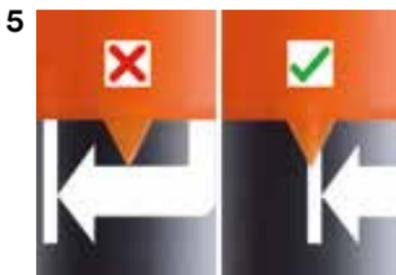
Para desbloquear la jeringa, gire completamente la punta de mezcla hasta que se detenga.
