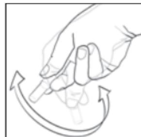
11. Aktivieren und inkubieren Sie an jedem Tag, an dem ein 1492V BI verarbeitet wird, mindestens einen nicht-verarbeiteten 1492V BI als Positivkontrolle. Befolgen Sie die oben stehende Aktivierungsanleitung in Schritt 10. Schreiben Sie ein „K“ (für „Kontrolle“) und das Datum auf das BI-Etikett. Die Positivkontrolle muss aus derselben Charge stammen wie der verarbeitete Bioindikator. Die Positivkontrolle für den BI bestätigt Folgendes:
