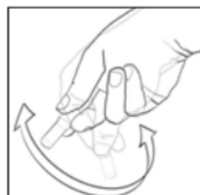
11. Por cada día que incube un IB 1492V procesado, active e incube al menos un IB 1492V no procesado para usarlo como control positivo. Siga las instrucciones de activación del paso 10. Escriba una "C" (de "control") y la fecha en la etiqueta del IB. El control positivo debería ser del mismo código de lote que el indicador biológico procesado. El IB de control positivo ayuda a confirmar:
