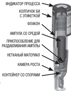
Рисунок 1. Схема биологического индикатора сверхбыстрого считывания 3М™ Attest™ Super Rapid Readout 1491
