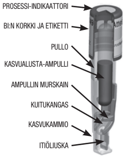
Kuva 1: 3M™ Attest™ Super Rapid Readout Biologisen pikaindikaattorin 1491 rakenne
