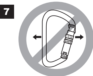
CROSS GATE LOADING CARGA DE LA COMPUERTA TRANSVERSAL CHARGE PLACÉE DU CÔTÉ TAQUET
