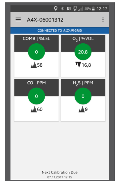
Visualización de lecturas en directo de gas del ALTAIR 4XR en un smartphone Android
