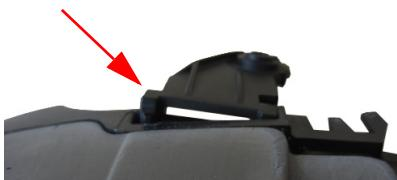
Fig. 5 Mauvais assemblage
