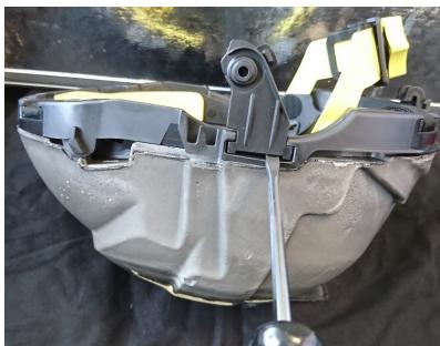
Fig. 2 Positionnement du tournevis
