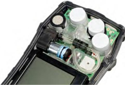
Fig. 14 Substituição do sensor
