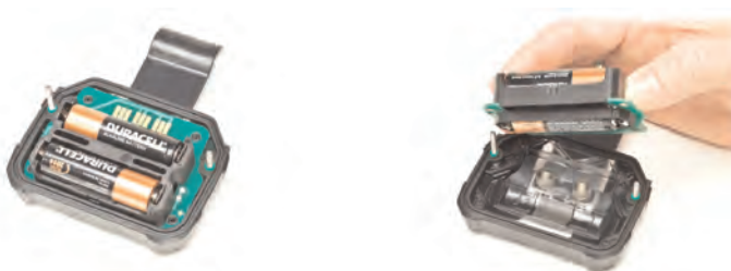
Figure 4-2. Remplacement des piles
