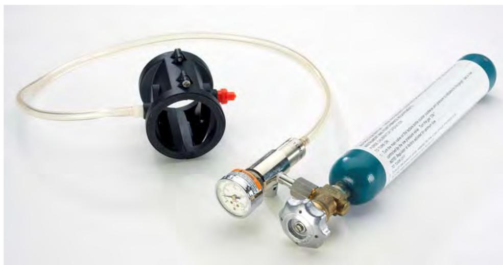
Портативный калибратор General Monitors является компактным, точным и надежным средством обслуживания газоанализаторов, при этом он содержит баллон с газом невзрывоопасной концентрации. Баллон заполнен стандартной смесью воздуха и газа в концентрации 50% НКПР. Использование газовых смесей известной концентрации позволяет избежать ошибок при проведении калибровки в
