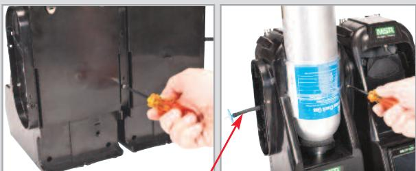
Hvis du bruker MSA cylinderholdere, skal cylinderholderen lengst til venstre ha festet et friskluftfilter på top port.
