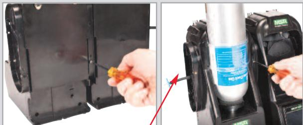
Якщо використовуються тримачі балона MSA, до верхнього порту найлівішого тримача балона необхідно прикріпити фільтр свіжого повітря.
