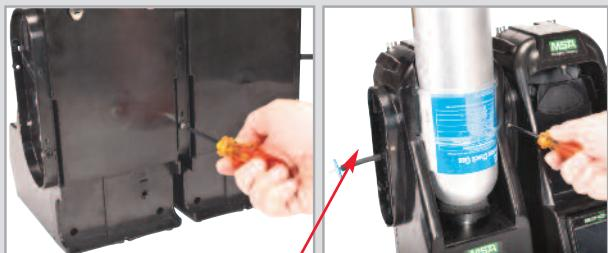
Eğer MSA silindir tutucuları kullanılıyorsa, en soldaki silindir tutucunun üst kısmında yer alan bağlantı noktasına temiz hava filtresi tutturulmuş olmalıdır.
