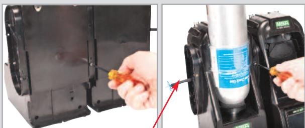
Se estiver usando Suportes de Cilindro MSA, o suporte de cilindro na extrema esquerda deve ter um filtro de ar fresco instalado na entrada superior.
