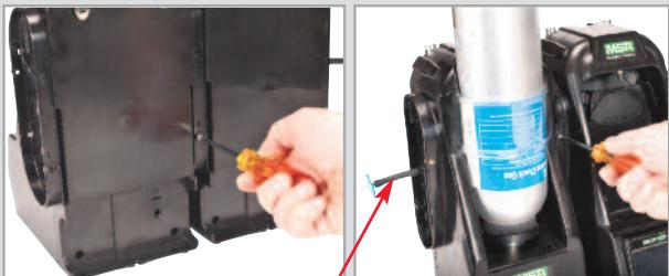
Si des supports de bouteille MSA sont utilisés, un filtre air frais doit être installé sur le port supérieur du support de bouteille le plus à gauche.
