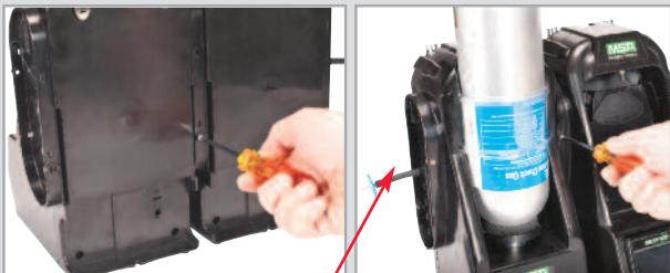
Pokud používáte držáky láhví MSA, k hornímu portu držáku láhví umístěnému nejvíce vlevo musí být připevněn filtr čistého vzduchu.
