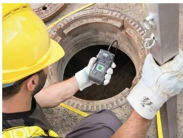
manera en el caso que un trabajador sufra un accidente (no necesariamente por exposición a gases) y quede detenido el detector alarmará para socorrer al accidentado.
