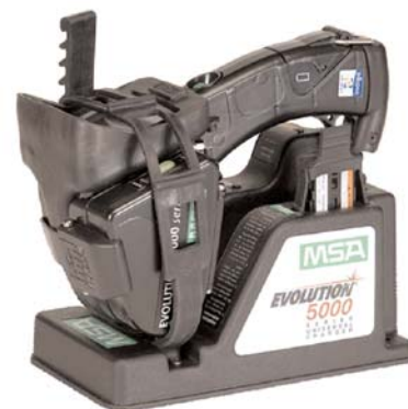
Figure 9. Étapes d'installation de la caméra sur le chargeur universel
