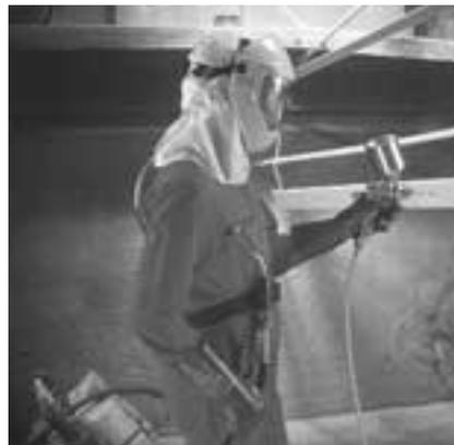
Die moderne Leichthaube „Cavair LDA“ liefert einen hohen Tragekomfort auch bei längeren Einsatzzeiten. Besonders geeignet ist sie als dauerhafter Schutz gegen schädliche Dämpfe, Gase, Staub, Chemikalien und herumfliegende Teilchen. Die Atemluftzufuhr erfolgt über einen Zuführungsschlauch, der über das am Leibgurt befestigte Regelventil mit der Luftquelle verbunden ist. Das Spritzvisier kann bei Verschmutzung leicht entfernt werden.
