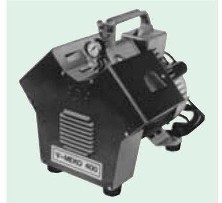
Der Membrankompressor V-Meko 400 ist ein kleiner, tragbarer Kompressor mit einer Ansaugleistung von 360 l/min. und einem Mitteldruck von ca. 5 bar. Der Kompressor liefert ölfreie Luft, so daß auf zusätzliche Filter verzichtet werden kann.
