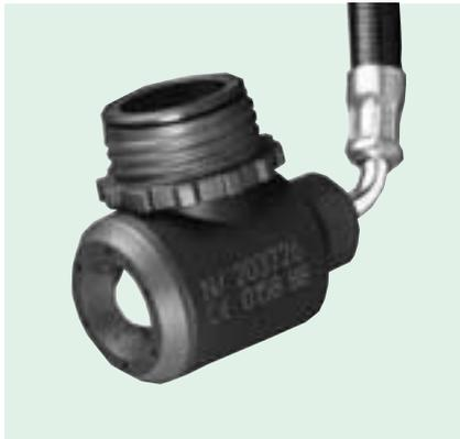
Der LA 88-N ist ein Normaldruck-Lungenautomat in besonders kleiner und leichter Bauweise. Eine Servo-Steuerung regelt die Luftzufuhr. Die drehbar gelagerte Mitteldruckleitung folgt den Kopfbewegungen besonders gut, so dass der Gerätträger nicht behindert wird. Die Verbindung zur Vollmaske ist ein Handrad mit Gewinde nach EN 148-1 [Rundgewinde].
