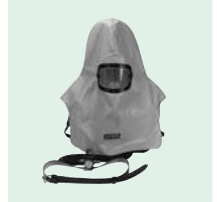
Die Strahlerschutzhaube Strahler Cap Light besteht aus einer Silikon-Vollmaske mit großer Sichtscheibe, einer auswechselbaren Folien-Zusatzscheibe und einer Siebscheibe als Schutz gegen mechanische Beanspruchung durch das Rückprallgut. Die Vollmaske ist fest mit einer Schutzhaube verbunden, die den Schulter- und Brustbereich bedeckt.
