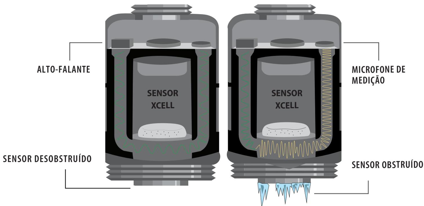
O monitoramento de difusão avisa se a entrada do sensor está bloqueada e incapaz de detectar os gases. Para fazer isso, o dispositivo usa um design mecânico acústico patenteado e algoritmos exclusivos para medir o som na entrada do sensor. Caso a entrada estiver bloqueada com algum material, como gelo, a diferença no som é detectada e o estado do dispositivo mudará para "Falha". Quando a obstrução é removida, o monitoramento de difusão a detecta e o dispositivo retorna à operação normal.
