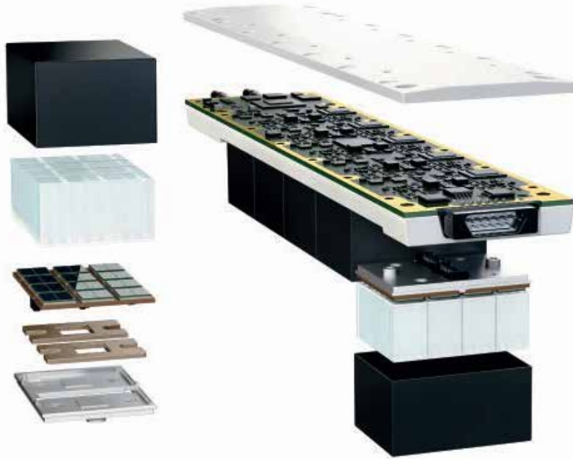
Şekil 3. MR uyumlu PET dedektörü. 25 cm'lik Aksiyel FOV için her bir dedektör bloğu 5 cm'yi kapsar. Entegre, su soğutmalı dijital elektronikler TOF rekonstrüksiyonu için 500 ps altı bir zamansal çözünürlükle anihilasyon olay algılamasını destekler.
