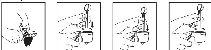
3. Coloque la canasta del filtro debajo del cabezal de preparación moviendo primero el seguro para fijar el filtro hacia atrás, coloque el mango de modo que éste se alinee con el icono abierto "■" y se ajuste en la ranura. Después, lentamente gire a la derecha hasta que la canasta del filtro quede localizada en la posición de cierre (refiérase al diagrama localizado en el panel frontal de la unidad tal y como está ilustrado a continuación).
