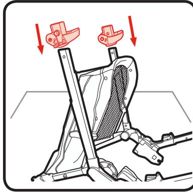
1. Empuje los montantes de los frenos para sujetarlo al armazón del cochecito. Las palancas del freno deben apuntar hacia la parte trasera del cochecito.
