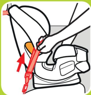
**LATCH se puede utilizar solamente si el espaciamiento de anclaje es de 11 pulgadas (28 cm) desde el centro de uno de anclaje LATCH al centro del otro anclaje LATCH.**
