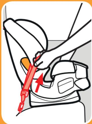
**LATCH se puede utilizar solamente si el espaciamiento de anclaje es de 11 pulgadas (28 cm) desde el centro de uno de anclaje LATCH al centro del otro anclaje LATCH.**
