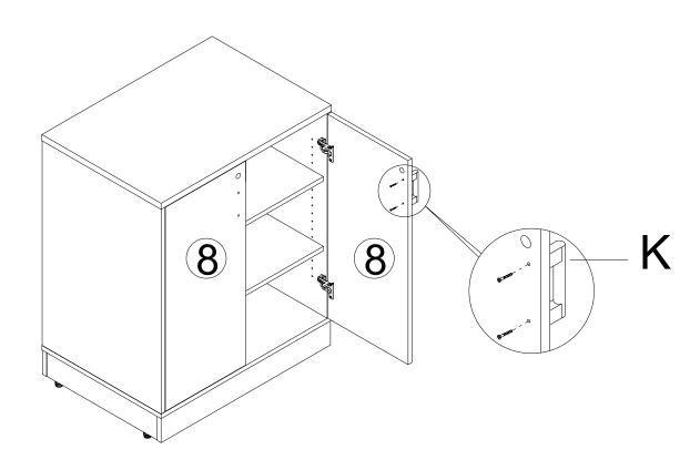
10. INSTALL LOCKS ON DOOR ® AND UNDERSIDE OF TOP ①. ONE PER DOOR. H(2x)
