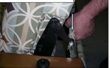
2. SLIDE LOWER BACK BOLT DOWN THE BACK BRACKET AS SHOWN
