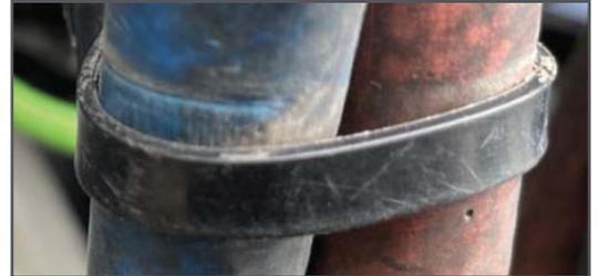
Le Tri-Sep crée un tampon et protège les câbles lors de l'installation sécurisée des serre-câbles.
