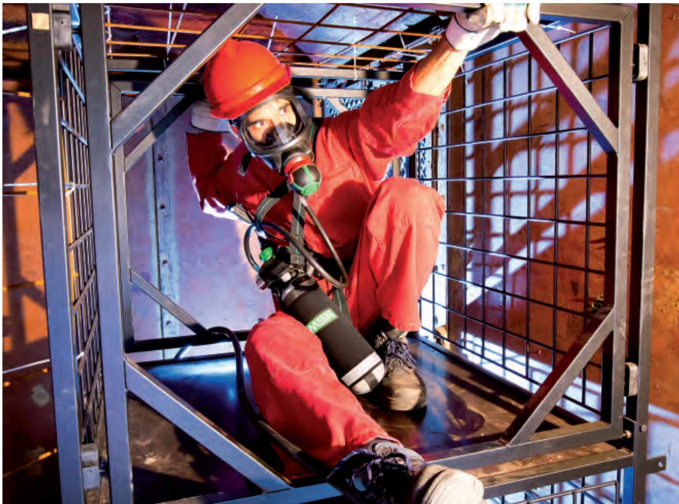
I sistemi Airline sono adatti a interventi di lunga durata in un luogo specifico o in ambiente ostile, ad esempio nei casi in cui un ingresso angusto non consente l'uso di autorespiratori ad aria compressa. È possibile scegliere tra sistemi ad aria compressa e ad alimentazione d'aria esterna.
