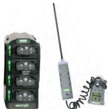
Chargeur multi-détecteurs vertical et pompe de prélèvement ALTAIR
