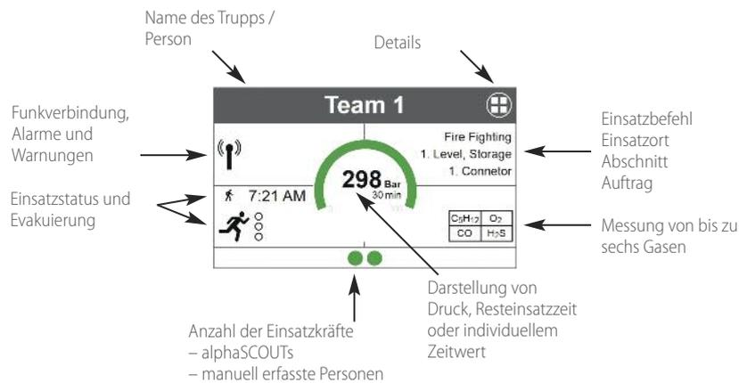
Mit der Softwareanwendung kann problemlos zwischen mehreren Seiten geblättert werden, um bei Bedarf weitere Information anzuzeigen, z.B. die gegenwärtigen Messwerte des ALTAIR 5X W-USB, und dennoch die Luftversorgung im Auge zu behalten.
