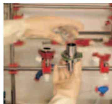
La norme EN 943 Parties 1 et 2 nécessite une multitude de tests mécaniques. La couture d'assemblage est soumise à un test d'arrachement, et il y a également des tests de résistance à la perforation, à l'abrasion et aux craquelures par flexion.
