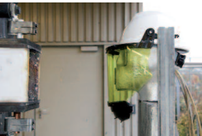
Łuk elektryczny MSA ustawiony przed testowaniem „arc-in-the-box” 7 kA
