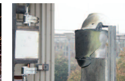
Certification obtenue conformément à la norme GS-ET-29 classe 2-7 kA. L'ensemble tête et visage protège l'utilisateur
