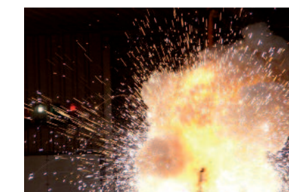
Arc électrique 7 kA
