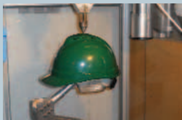
Penetrationstest av V-Gard 500
