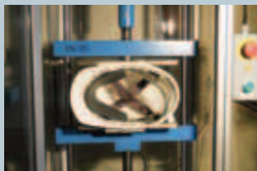
V-Gard 500 протестировано на боковую деформацию
