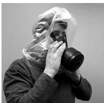
4. Ajuster le harnais en saisissant l'arrière de la cagoule et le tirer en position de sorte que le harnais se loge sur le dessus de la tête.
