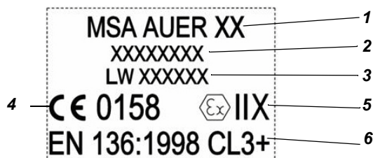
Fig. 2 Marcado del cuerpo de la máscara completa
