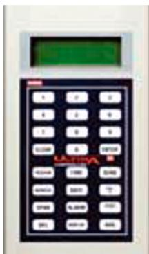
Le Controller de la série ULTIMA/ULTIMA X avec son interface IR non-intrusive assure toutes les fonctions du Calibrator et d'avoir accès aux fonctions suivantes :
