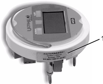
Fig. 8 PCB [Carte de circuit imprimé]
