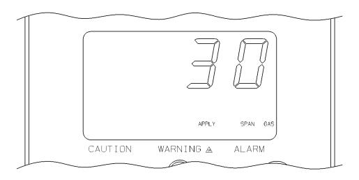
Fig. 32 Apply Span Gas Flag
