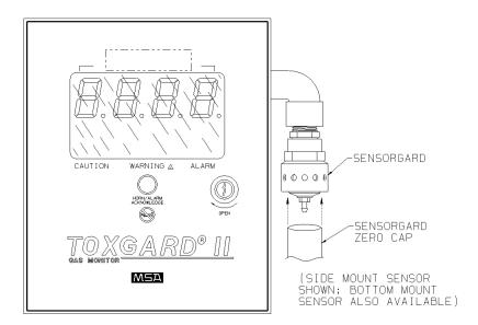
Fig. 24 Zero Cap Placement
