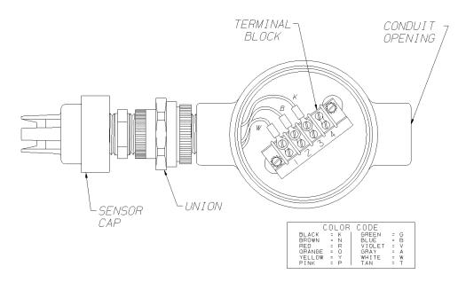
Fig. 9 Combustible Remote Sensor
