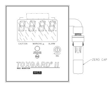
Fig. 30 Zero Cap Placement
