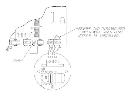
Fig. 13 Pump Wiring
