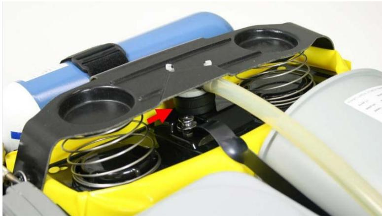
Fig. 52 Sealing cap
