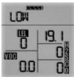
Figure 3-6a. Instrument en alarme d'oxygène
