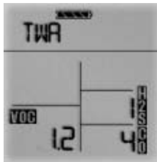
Figure 3-13. Page d'exposition avec alarme MPDT (TWA)
