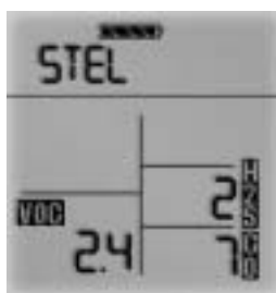
Figure 3-12. Page d'exposition avec alarme LECT (STEL)
