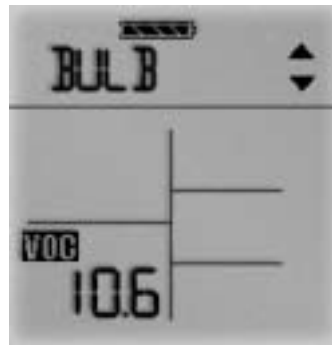
Figura 3-16: Cambio de selección de bombilla de PID
