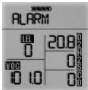
Figura 3-7b: El instrumento en la alarma de gas VOC
