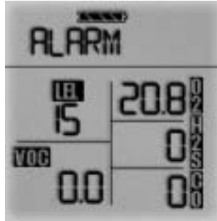
Figura 3-5b: El instrumento en la alarma de LEL
