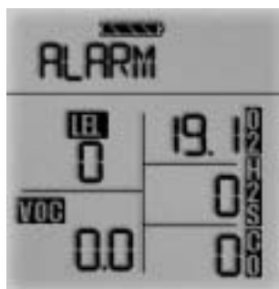
Figure 3-6b. Instrument en alarme d'oxygène
