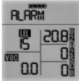
Figure 3-5b. Instrument en alarme LEL (LIE)
