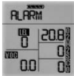
Figure 3-4b. Alarme de pompe sur l'écran
