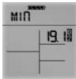
Figura 3-11: Lectura de VALOR MÍNIMO en la pantalla
