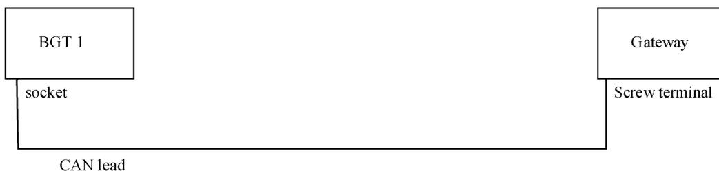
Abb. 137 Anschluss SUPREMA Gateway CAN/Profibus DP
