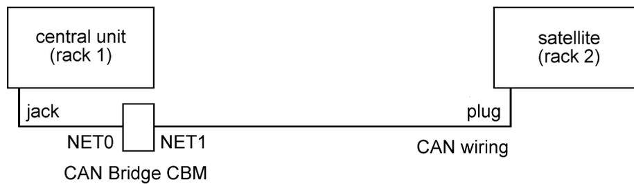
Abb. 100 Anschluss CAN-Brücke CBM
