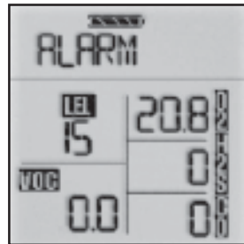
Bild 8: Instrument i LEL-larmläge
