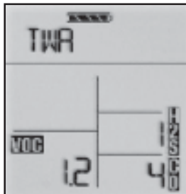
Bild 12: Exponeringssida med STEL- eller TWA-alarm
