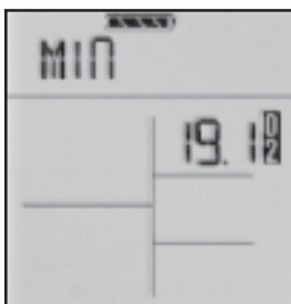
Bild 11: Toppvärden (PEAK) och lägsta värden (MIN) för syrgas visas
