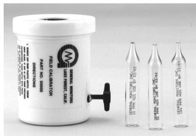
**Figura 16: Ampolas com cilindro de quebra**
