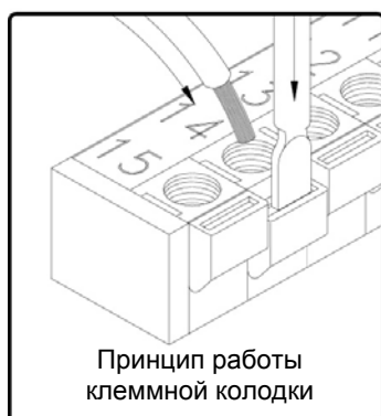
Рисунок 14. Принцип работы клеммной колодки с пружинными клеммами
