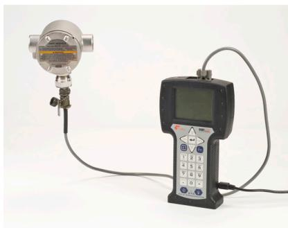
Fig. 9 Dispositif portable HART
