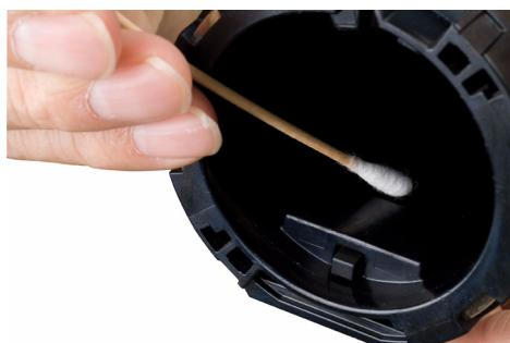
Fig. 21 Nettoyage de la diode de coupelle de calibrage
