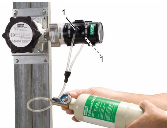
Fig. 15 Réglage du calibrage HART à distance
