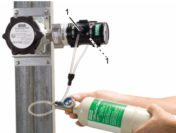
Fig. 15 Configuración de la verificación HART a distancia
