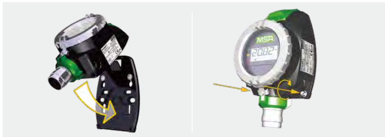
将安装背板固定在需要的位置，并确保探头指向朝下
