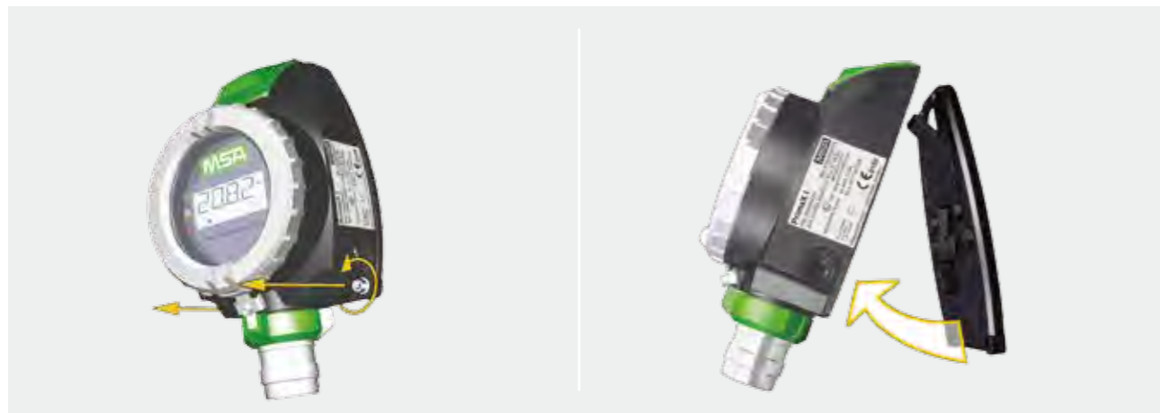
首先松开两个六角螺钉，探测器向上提起，拆下安装背板
