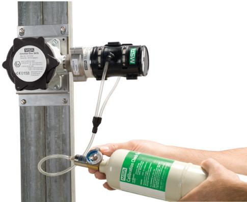
Fig. 11 Configuration du contrôle fonctionnel avec protection environnementale
