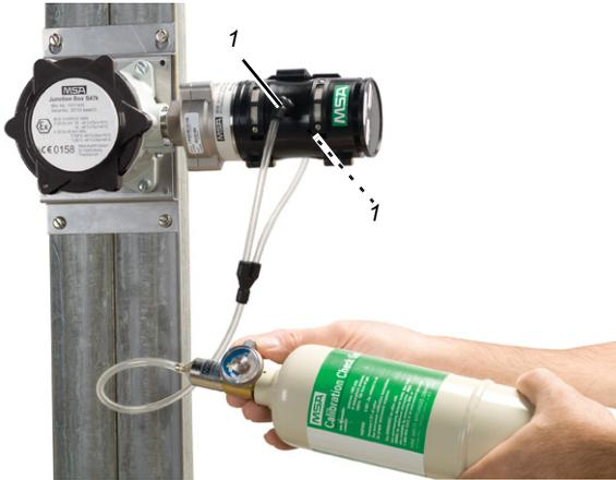
Fig. 16 Configuration du calibrage HART
