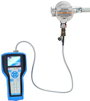
Fig. 9 Dispositif portable HART à distance
