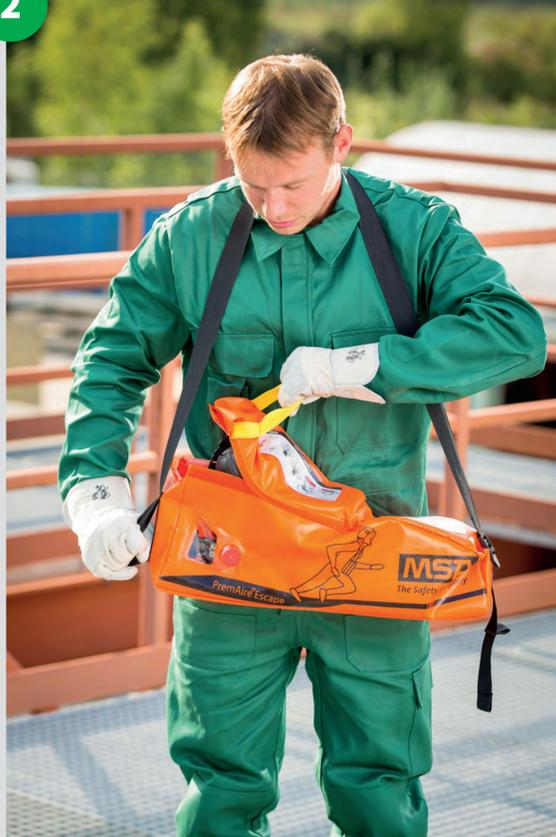
Im Notfall schwarze Halteschleufe greifen und Tasche durch Ziehen an gelber Schlaufe öffnen. (Luftversorgung ist automatisch aktiviert)
