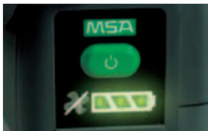
Controlado por microprocesador para seguridad extra. Combinación de indicadores LED/bocina señala cinco niveles reserva batería. Fácil operación con un pulsador dispone de paro diferido para evitar desconexión accidental.
