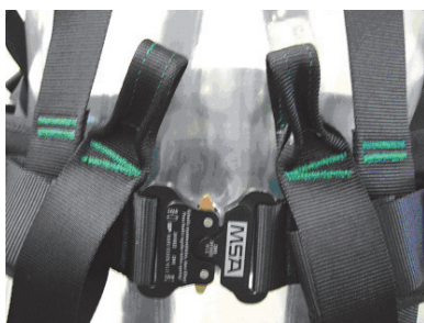
Ограничительная петля [EN 813] в передней центральной части поясного ремня, состоящая из двух текстильных петель.
