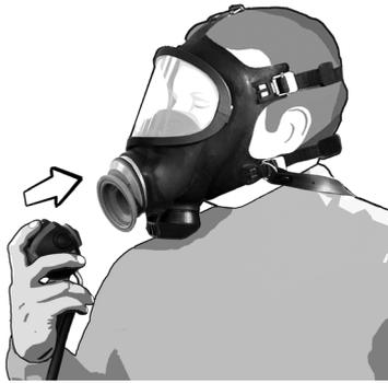
(22) Lungenautomaten in den Adapter an der Maske einführen, bis er spürbar einrastet.
