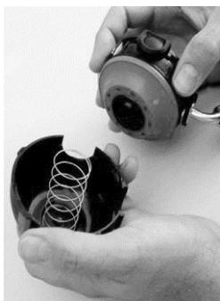
**Fig. 32** *Montaggio della ghiera*
