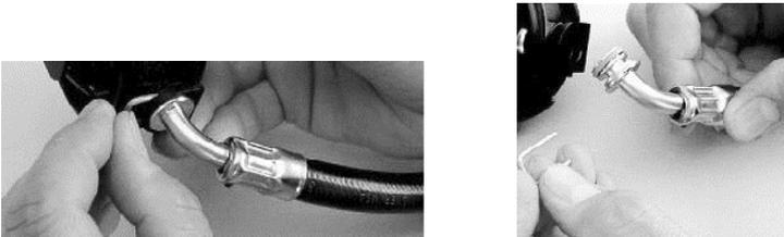
**Fig. 30 Smontaggio della linea di media pressione**
