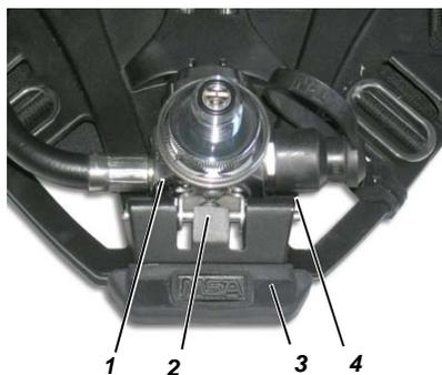
**Fig. 26** *Riduttore di pressione con paracolpi*
